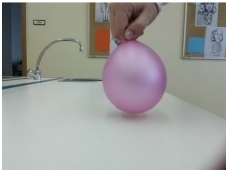
obr 1. Sublimace suchého ledu v nafukovacím balónku
